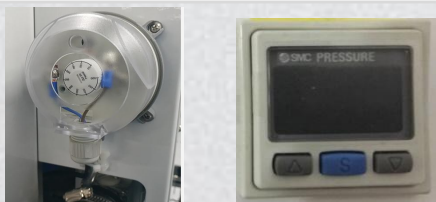
真空压差表, SMC气压监控
